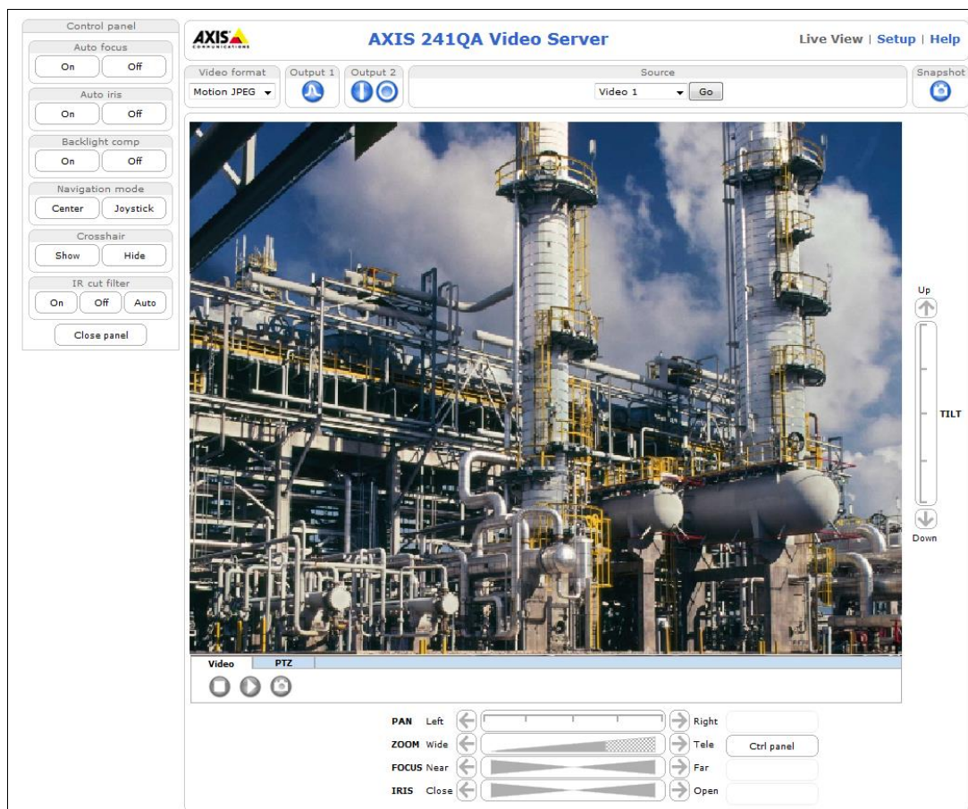
Bild 4.8 Steuerung und Visualisierung über einen Videoserver
