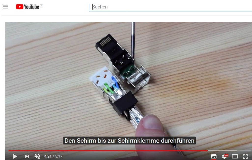
Bild 5-7 Stecker Belegung RJ45
