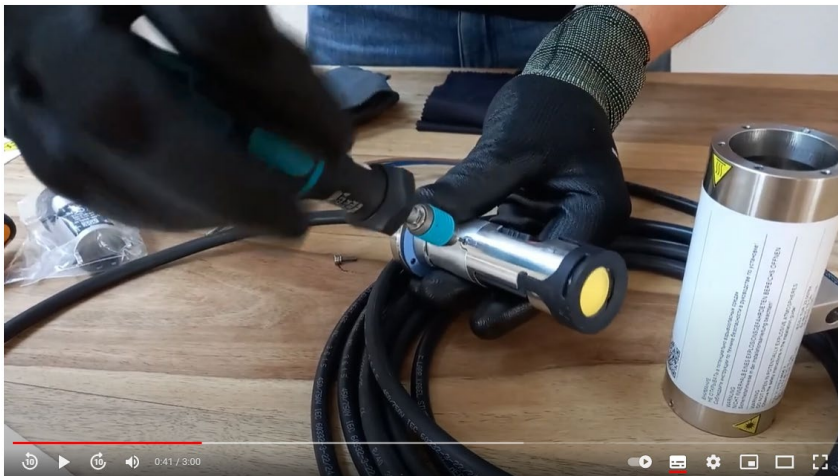
Bild 6-5 Austausch des Leuchtmittels liteServer Rough.micro
