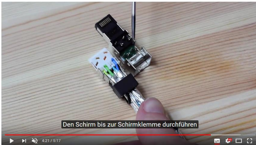
Bild 5-12 Stecker Belegung RJ45
