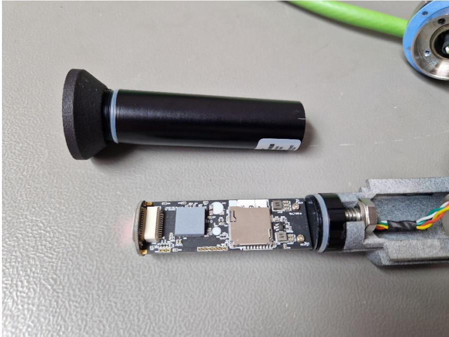
Bild 6-2 Position SD Karte im Kameramodul
