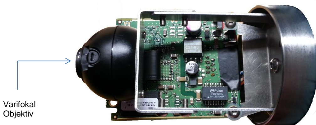
Bild 4.9 Objektiv und Platine der ToughCam IP
