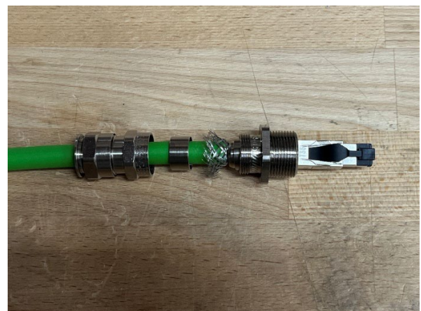
Abb. 2.8 – RJ45 in Kabelleitungseinführung
