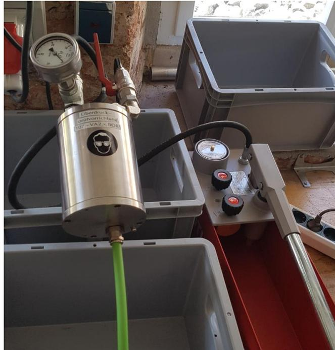
Bild 2-3: Druckprüfvorrichtungen für Kabel-KLE Kombinationen
