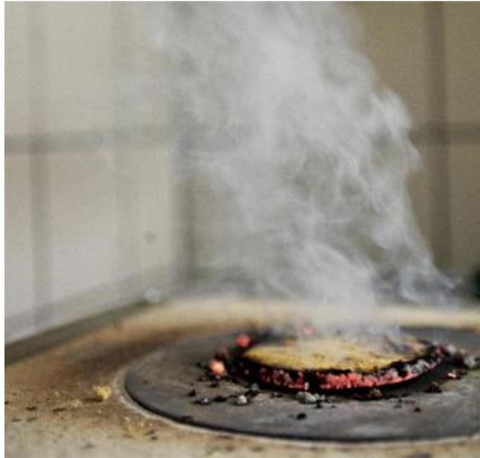
Bild 4-1: Prüfung der Glimmtemperatur<sup>4</sup>
