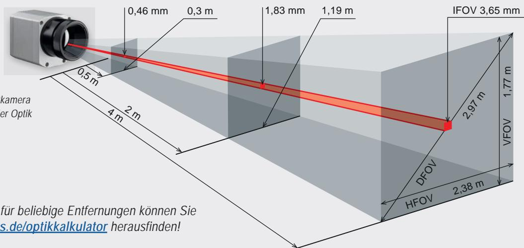
Messfeld der Infrarotkamera PI 640 am Beispiel der Optik 33° x 25°
