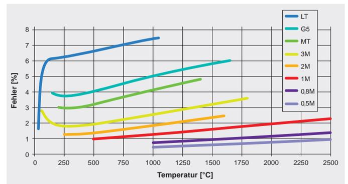
Messfehler bei 10 Prozent falsch eingestelltem Emissionsgrad in Abhängigkeit von der Wellenlänge und Objekttemperatur (LT: 8–14 μm; G5: 5 μm; MT: 3,9 μm; 3M: 2,3 μm; 2M: 1,6 μm; 1M: 1,0 μm); 0.8M: 800 nm; 0.5M: 525 nm.
