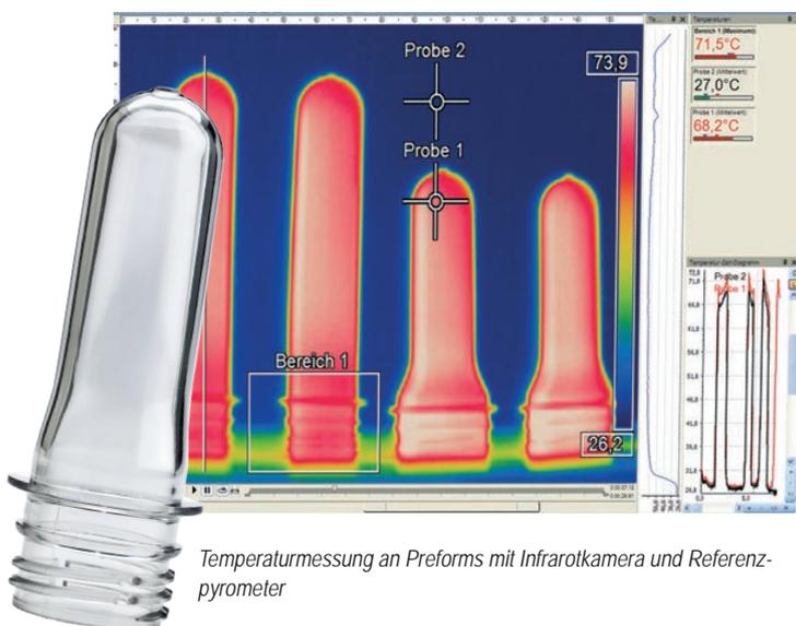
Da der Zeitpunkt des Durchlaufs der Probekörper variieren kann, muss eine Videosequenz bei 120 Hz aufgezeichnet werden, um das Temperaturprofil eines Preforms zu messen. Die Kamera wird dabei so positioniert, dass sie der Bewegung des Materials aus einem schrägen Winkel – ähnlich dem letzten Wagen eines fahrenden Zuges – „hinterher schaut“. Im Ergebnis erhält man das für die Einstellung von Heizparametern wichtige Temperaturprofil aus einer Infrarot-Videosequenz.
