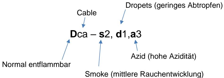
Für Gebäude mit höherem Sicherheitsbedarf wird mindestens die Brandklasse Cca empfohlen. Unsere Kabel und Leitungen sind nur in Klasse Dca eingestuft, weil sie nicht jährlich getestet werden. Können sie trotzdem verwendet werden?
