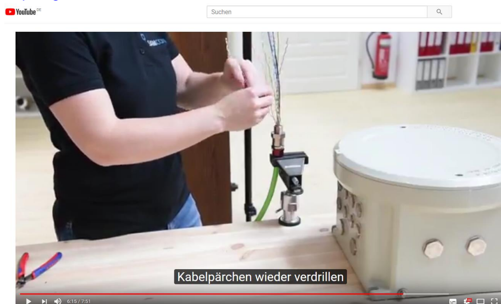
Илл. 5-8 Барьерное резьбовое соединение. Пару проводов закрутить снова.
